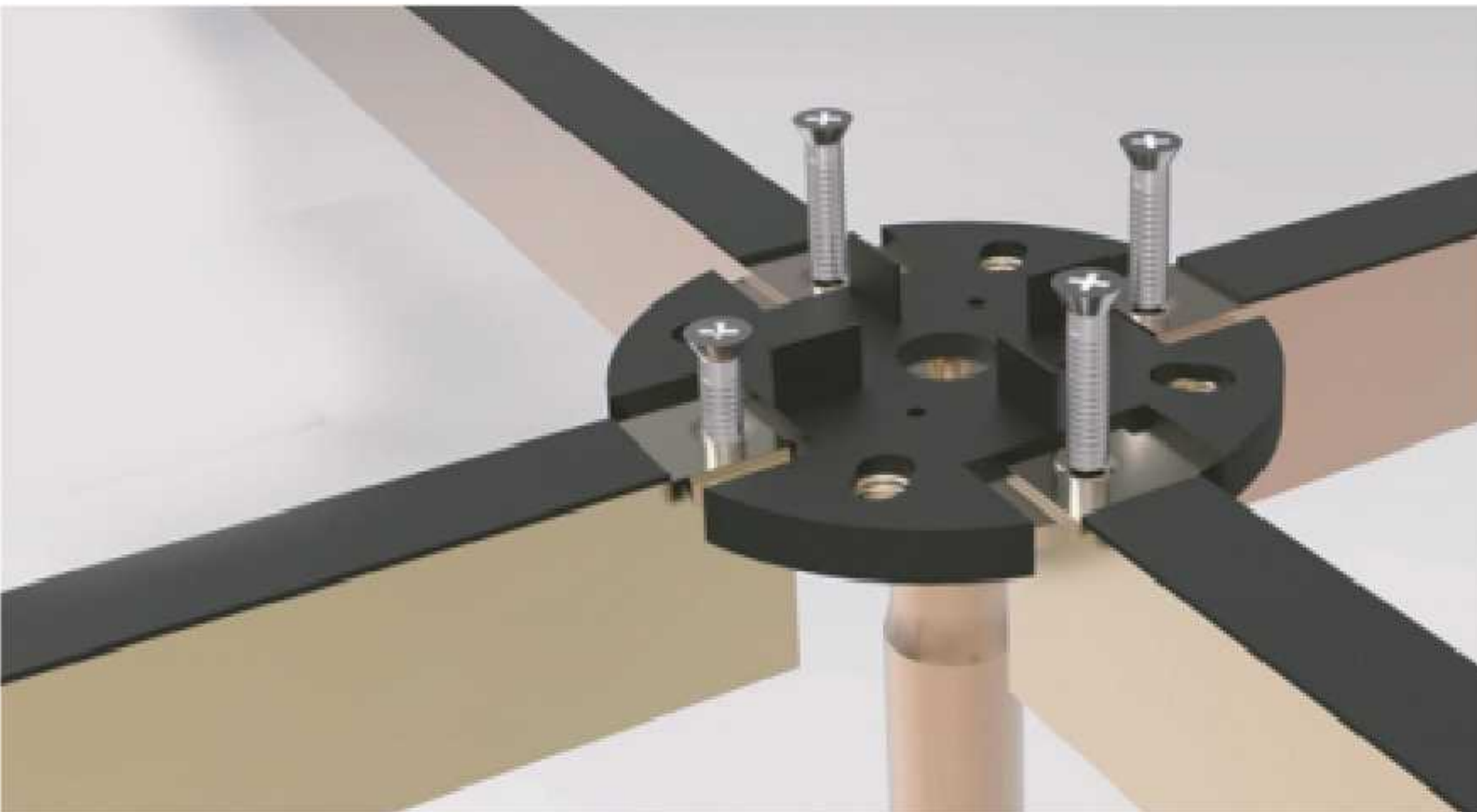
硫酸钙防静电活动地板连接示意图
